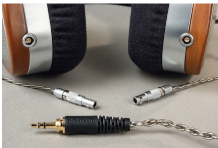
▲ Symetryczne wtyki LEMO umożliwiają błyskawiczną wymianę okablowania.
