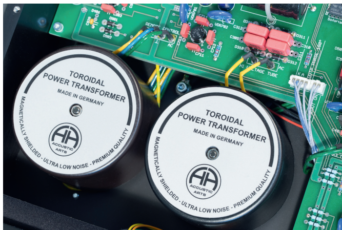
▼ Oddzielne zasilanie lamp i tranzystorów.
