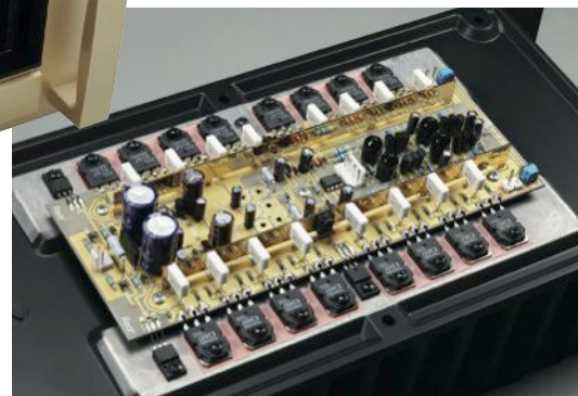
Końcówka mocy jednego kanału P-6100.
