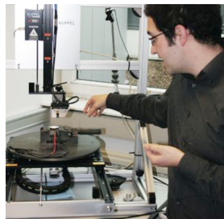
Zaawansowany skaner firmy Klippel bada laserem zachowanie membrany. Sprzęt drogi i chirurgicznie dokładny.
