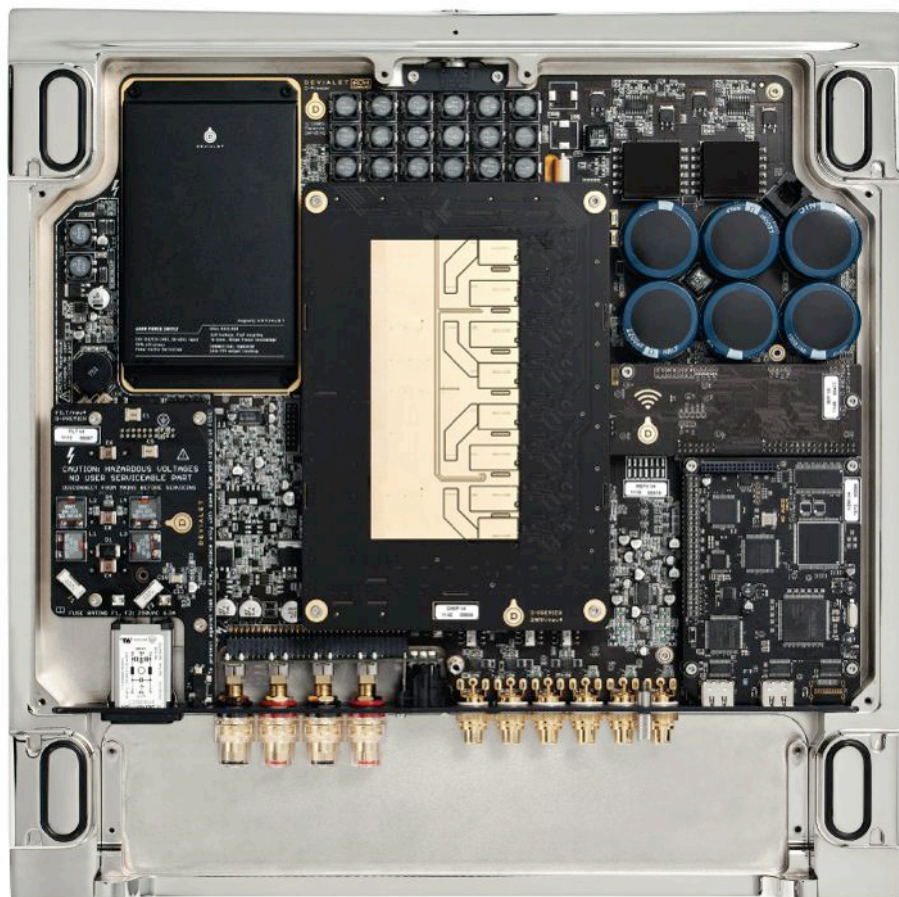
Z lewej zasilacz, z prawej preamp z modulem Wi-Fi, a w centrum cyfrowy wzmacniacz w klasie D.
