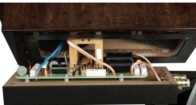
Rozbudowana zwrotnica tuż za gniazdami.
