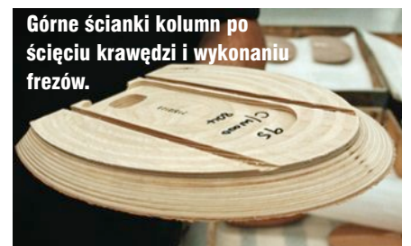
Wygięte płyty czekają na wycięcie wyłobień do montażu kratownicy Matrix.
