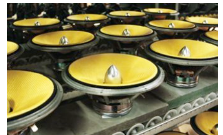
Przesycanie kewlarowych stożków spoiwem odbywa się ręcznie.
