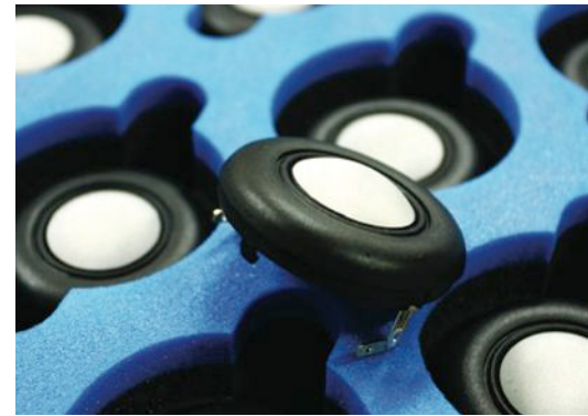
Tweetery czekają na montaż, ułożone w arkuszach grubej gąbki.
