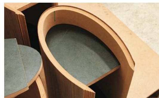
Wygięte płyty czekają na wycięcie wyłobień do montażu kratownicy Matrix.
