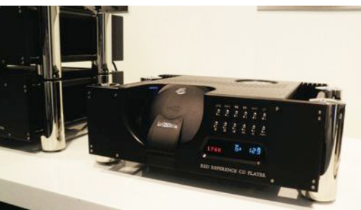
Red Reference MkII, czyli szczytowy odtwarzacz CD Chorda. Napęd Philips CD-2Pro, upsampler do 176 kHz oraz to, czego nie znajdziecie nigdzie indziej – zrobiony w większości na piechotę, autorski przetwornik c/a. 16000 euro to niemało, ale za tę cenę nabywacie konstrukcję unikalną w skali światowej.
