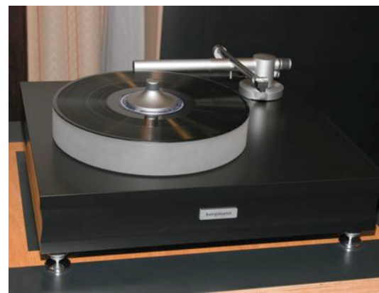
Bergmann Audio Sindre. Poduszka powietrzna pod talerzem i belką liniowego ramienia.
